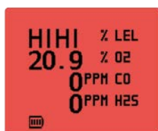
Display rosso in condizioni d'allarme
